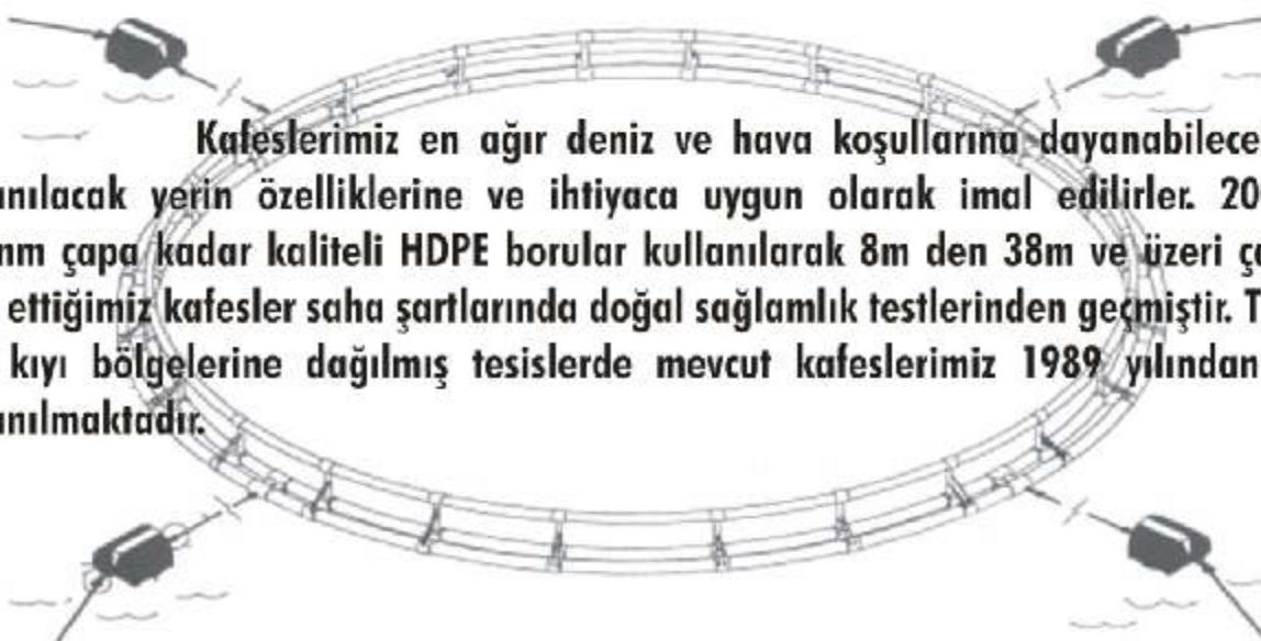
Kafeslerimiz en ağır deniz ve hava koşullarına dayanabilecek şekilde, kullanılacak yerin özelliklerine ve ihtiyaça uygun olarak imal edilirler. 200mm den 315mm çapa kadar kaliteli HDPE borular kullanılarak 8m den 38m ve üzeri çapa kadar imal ettiğimiz kafesler saha şartlarında doğal sağlamlık testlerinden geçmiştir. Türkiye'nin tüm kıyı bölgelerine dağılmış tesislerde mevcut kafeslerimiz 1989 yılından bu yana kullanılmaktadır.
